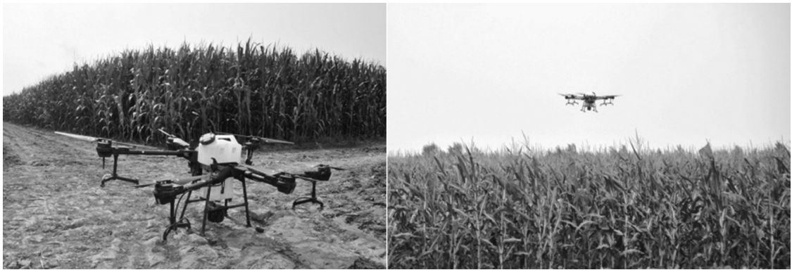
图1 供试无人机及其田间喷施作业图
